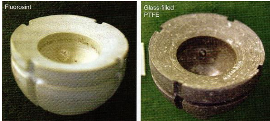
Figura 1.1. Patente de PTFE relleno bajo el nombre comercial de “Fluorosint” y PTFE con refuerzo de vidrio. (Kurtz, 2009).
