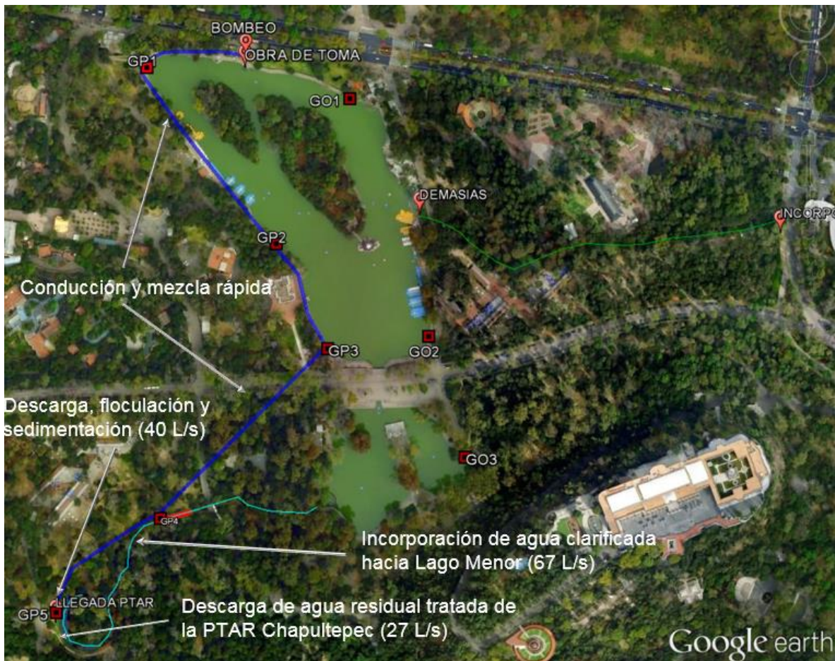
Figura 12. Sistema de recirculación existente y en operación.
