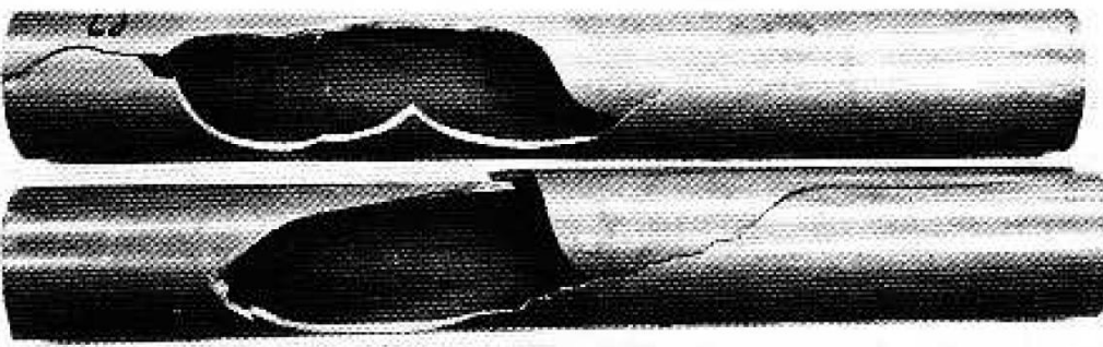
Figura 5.22. Fractura rápida en un tubo de PVC con aire atrapado, cuando se genera una velocidad de impacto grande
