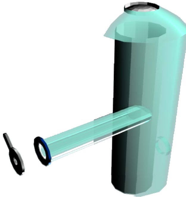
Figura 3. 10 Separador liquido-vapor y placa orificio (el autor).
