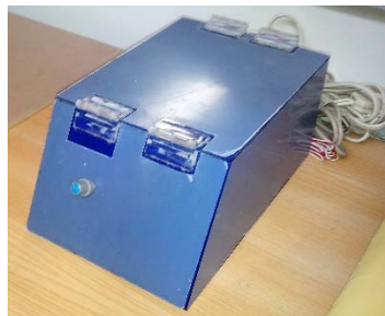
Figura 22. Módulo de electrónica para el control de la velocidad angular del sistema de colección.
