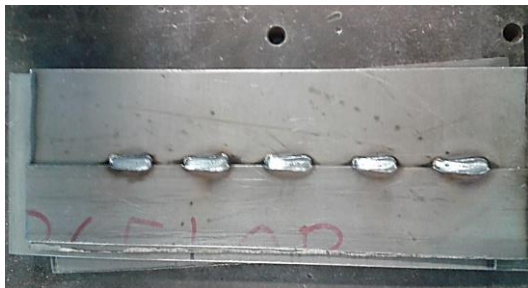
Figura 5.3. Soldeo de placas con proceso GMAW
