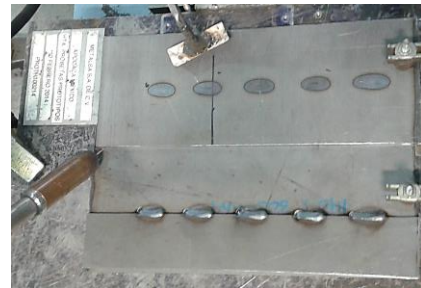
Figura 5.3. Soldeo de placas con proceso GMAW
