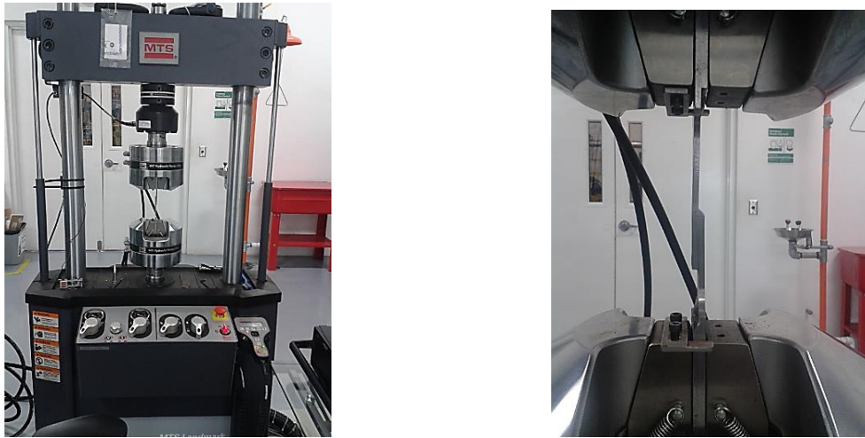
Figura 5.12. Montaje de muestra en equipo de pruebas de fatiga
