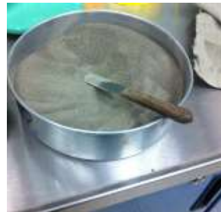
FIGURA 2.3 Suelo cribado por malla #60
