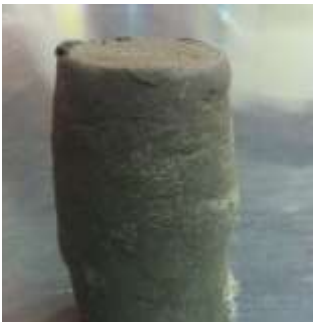
FIGURA 5.1 Probeta de suelo natural reforzada con fibras de PET al terminar un ensaye.
