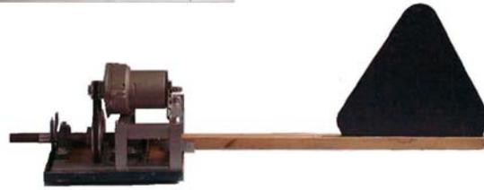
**Figura 4.6.** Ensamble de la veleta con la góndola
