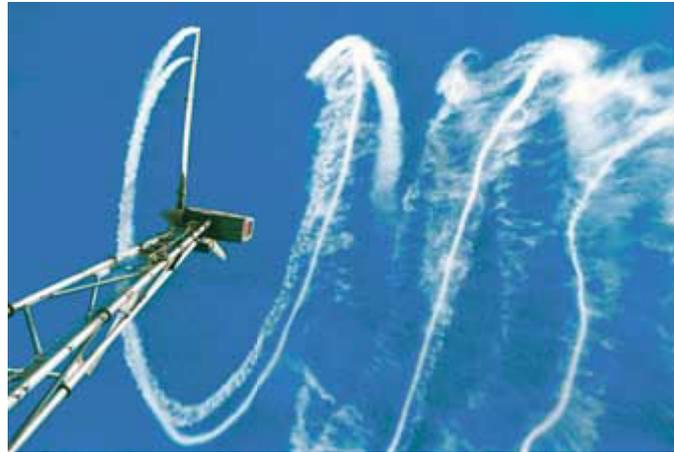
**Figura 2.4.** Estela producida por un rotor eólico monopala.
