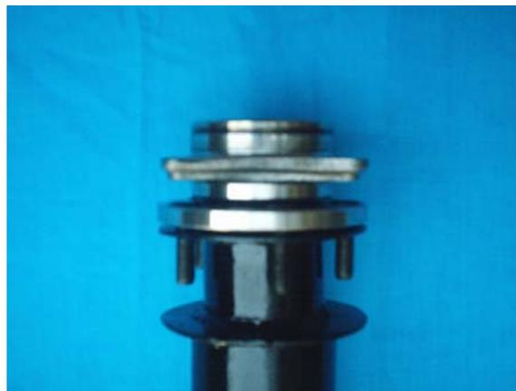
**Figura 4.8.** Ensamble torre – maza.
