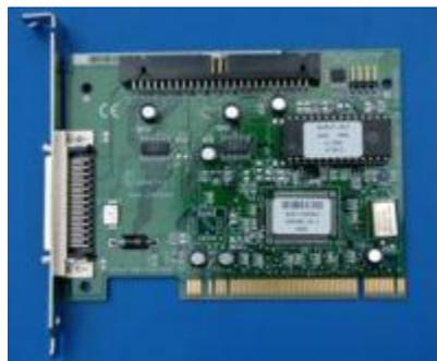
Fig. 2.13 Tarjeta PCI típica
