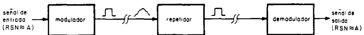
FIGURA 1.5: Descripción esquemática de un sistema de comunicación por medio de pulsos binarios
