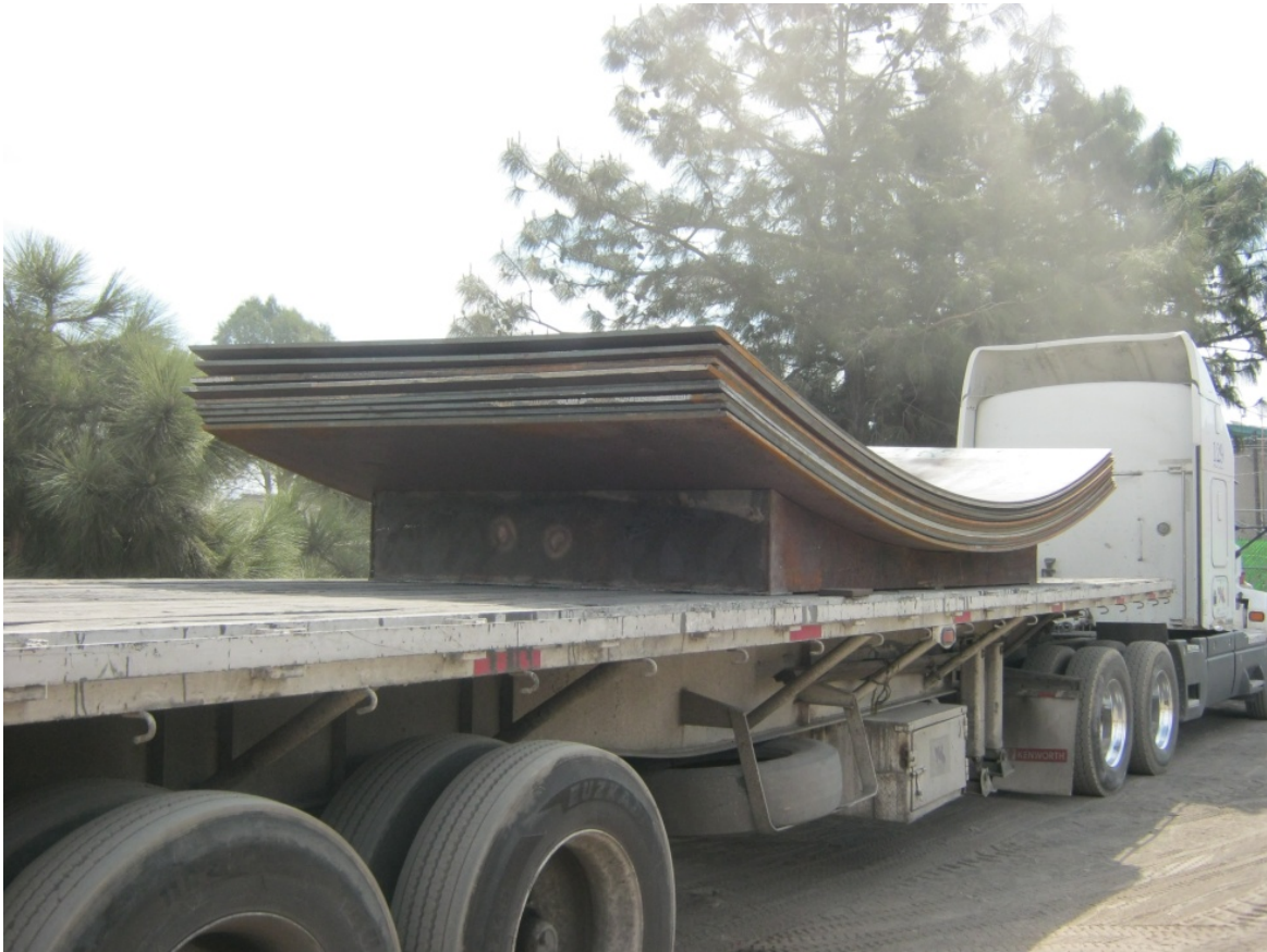
Figura 39. Envío de placa rolada al sitio de construcción.
