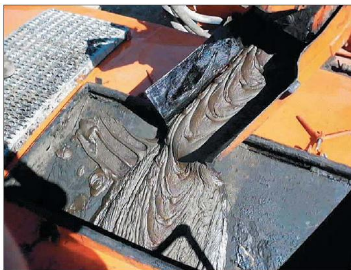
Figura 3.22. Lechada producida por el método “CHOPS” (Alboudware H., et. al., 2006. Fotografía: Cortesía de Maurice Dusseault).
