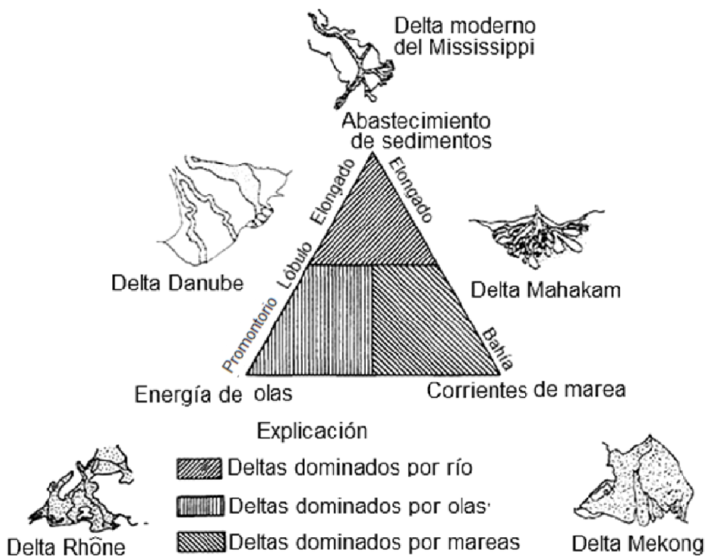
Figura 5.2 Figura triangular que muestra las relaciones del suministro de sedimento, olas, y corrientes de marea y morfología de deltas marinos resultantes.
