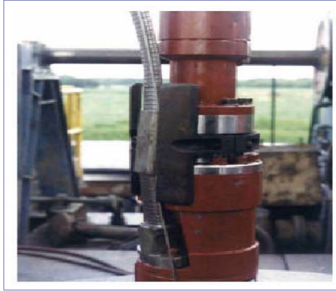
Figura 5.29. Dispositivo de conexión Mufa-Motor, así como el revestimiento metálico que le da mayor resistencia mecánica al cable conductor (Schlumberger 2003).
