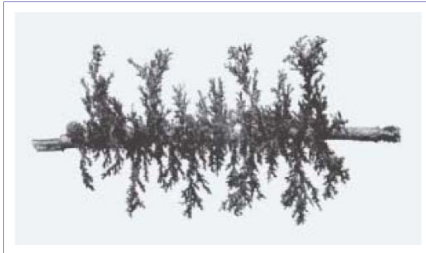
Figura 4.21. Modelo tomado después de una acidificación de la matriz con carbonato de calcio. Se observa la red de agujeros de gusano que se forman (Oilfield Review, 2004).
