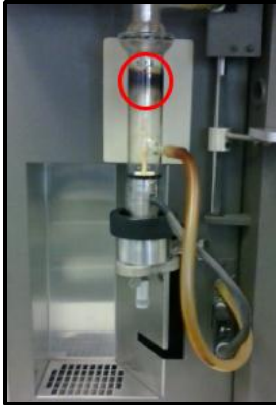
Figura 5-7. Muffa sucia debido a los gases liberados por las muestras.
