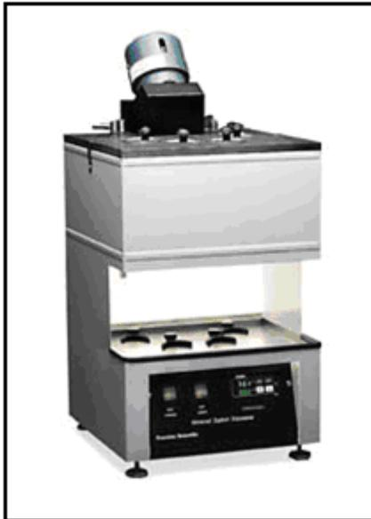
**Figura 2.20. Viscosímetro tipo Saybolt.**
