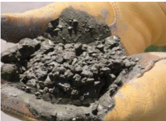
Mezcla con exceso de agua.
