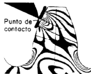
Figura 2. Concentración de esfuerzos en el diente del engrane [4]
