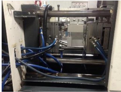
Figura 28 conexiones de refrigeración al molde de las bases
