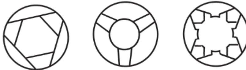
Figura 2 Patrones de segmentos en corazones colapsables
