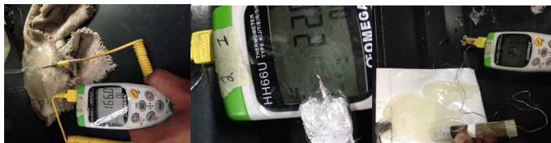
Figura 36 Dispositivos usados para la toma de temperatura de masa fundida
