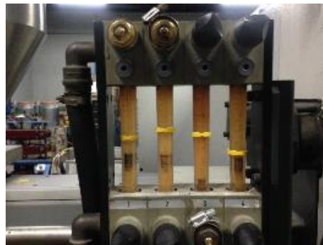
Figura 29 Fluxómetros de control para los cuatro canales de refrigeración en el equipo DEMAG ergo tech 50270
