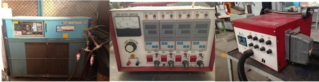
Figura 19 Enfriador de fluido para control de temperatura de moldes y garganta marca friomold y controlador de temperatura para los moldes de inyección, en el Laboratorio de Procesamiento de Plásticos, Facultad de Ingeniería, UNAM CU.
