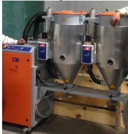
Figura 20 Equipo para remoción de humedad de la materia prima
