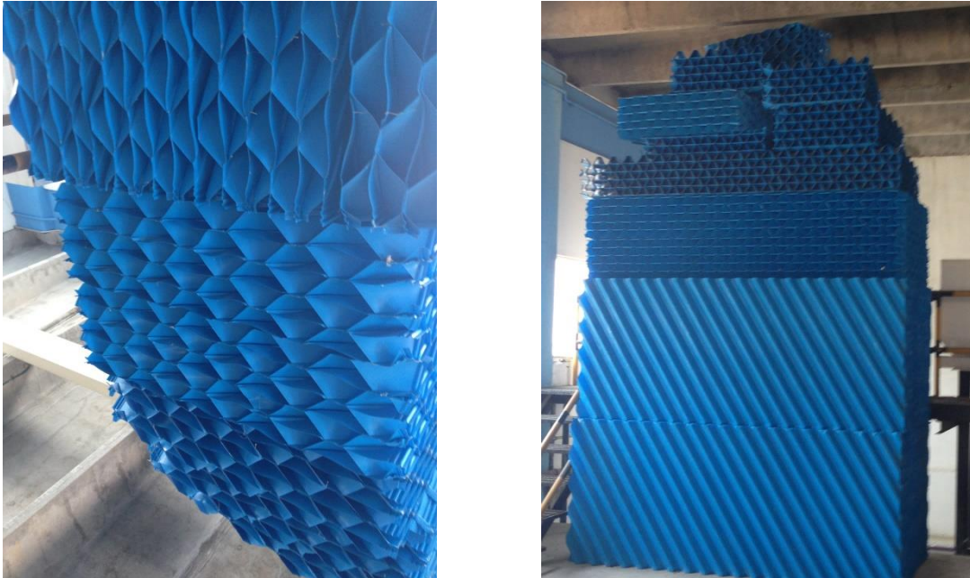
Figura 5.13. Módulos de alta tasa tubulares.
