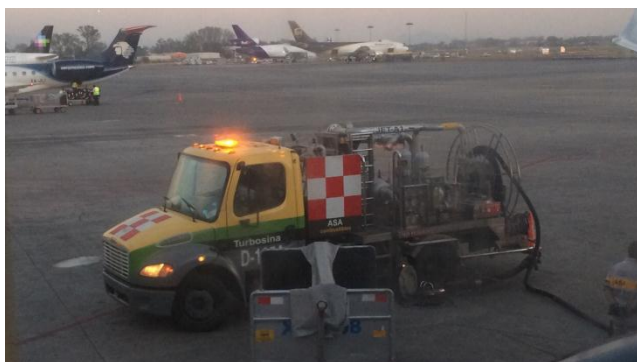
Ilustración 7, Camión de carga de turbosina de ASA. Fuente: Verónica Garzón. Aeropuerto Internacional de Chihuahua.
