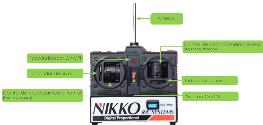
Figura 2. Control remoto para el movimiento de Hugo, colocar los indicadores de nivel centrados
