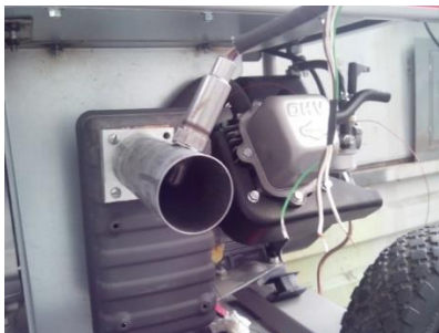
Figura 2.22 Conexión física del sensor de oxígeno.
