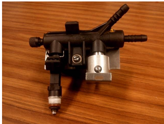
Figura 4.27 Ensamble del inyector junto con las salidas de combustible.
