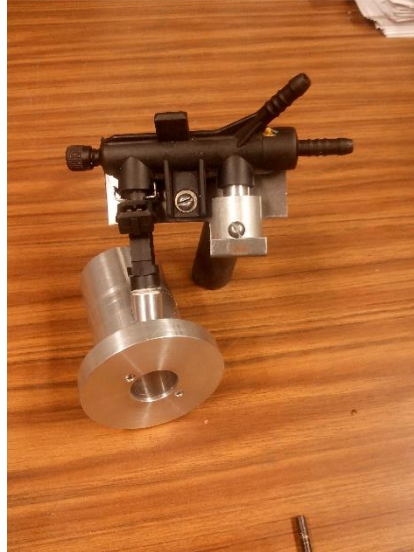
Figura 4.28 Ensamble del inyector por interferencia.
