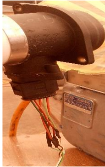
Figura 2.5 Conexión sensor MAF.
