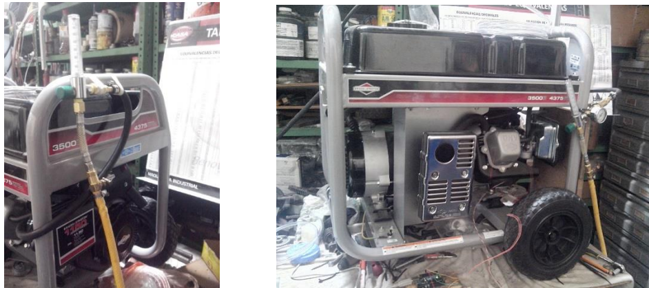
Figura 4.15 Conexiones físicas de mangueras motor dual.
