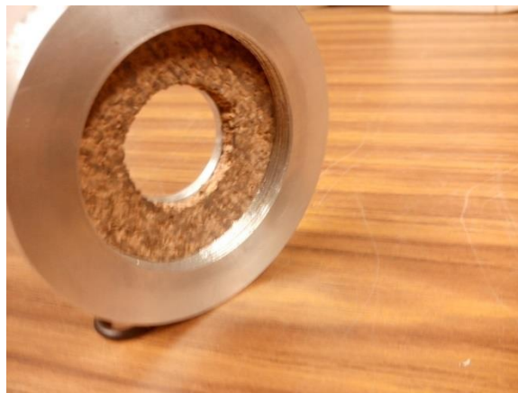
Figura 4.21 Base del mezclador terminada.
