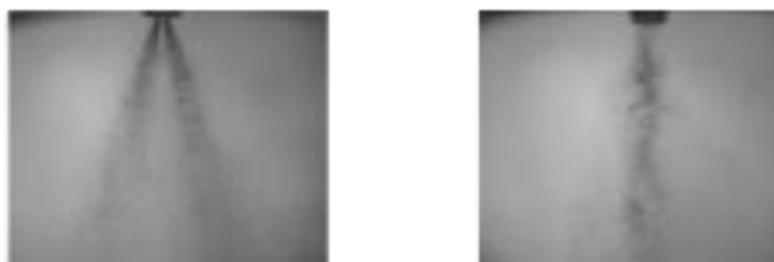
Figura 2.29 Patrón de atomización ideal (izquierda) incorrecto (derecha).
