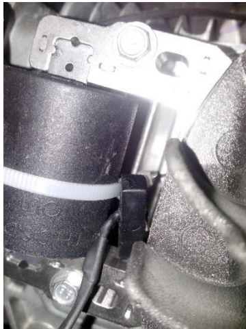
Figura 4.11 Colocación del sensor de efecto hall en el motor.
