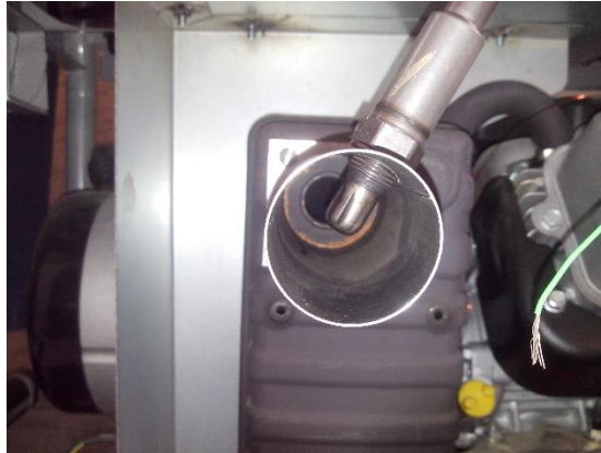
Figura 4.6 Ensamble final del sensor de oxígeno.
