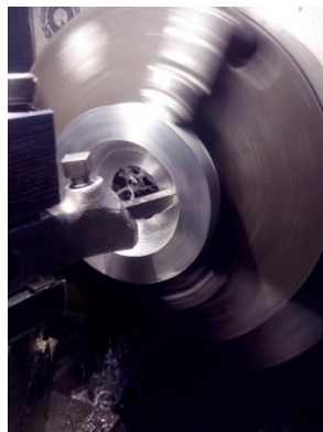
Figura 4.19 Fabricación base de mezclador.
