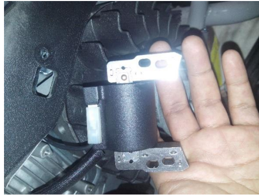
Figura 4.10 Bobina de ignición y su ubicación en el motor.
