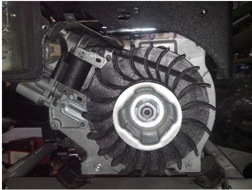
Figura 4.10 Bobina de ignición y su ubicación en el motor.
