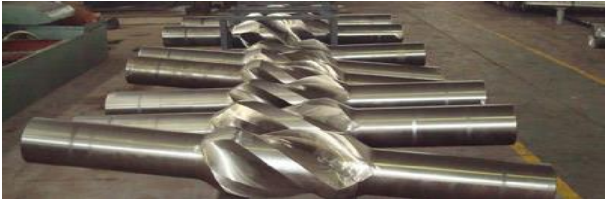
Figura 58. -Representación de estabilizadores usados en la perforación de un pozo geotérmico (Manual de Perforación Halliburton)
