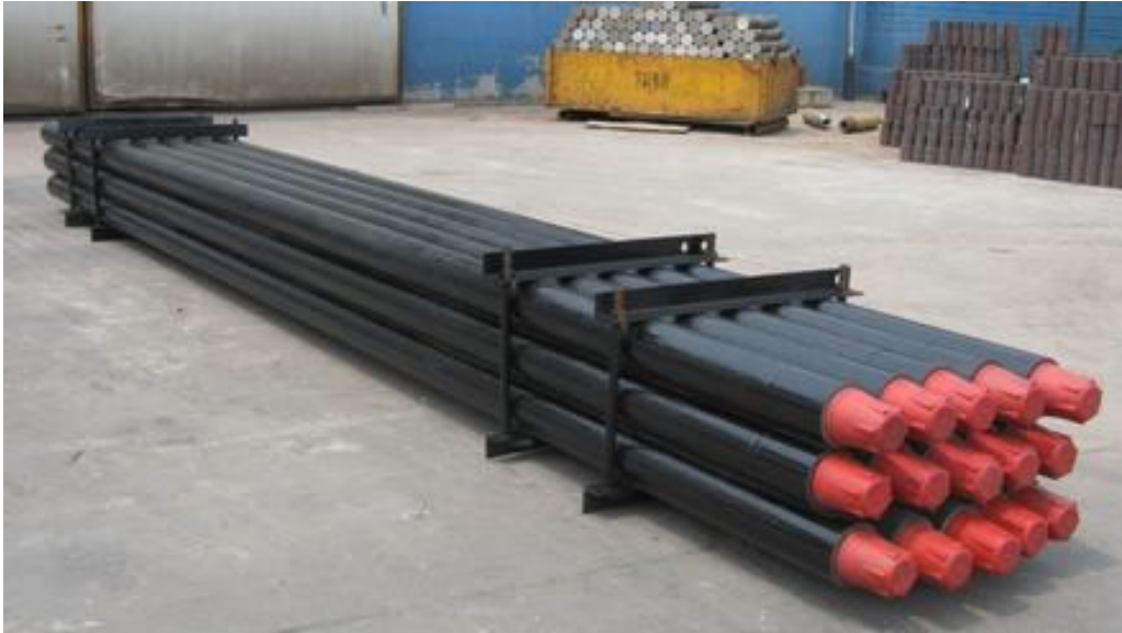
Figura 56.- Representación de una tubería ( drill pipe ) usada en la perforación de un pozo geotérmico (Manual de Perforación Schlumberger)
