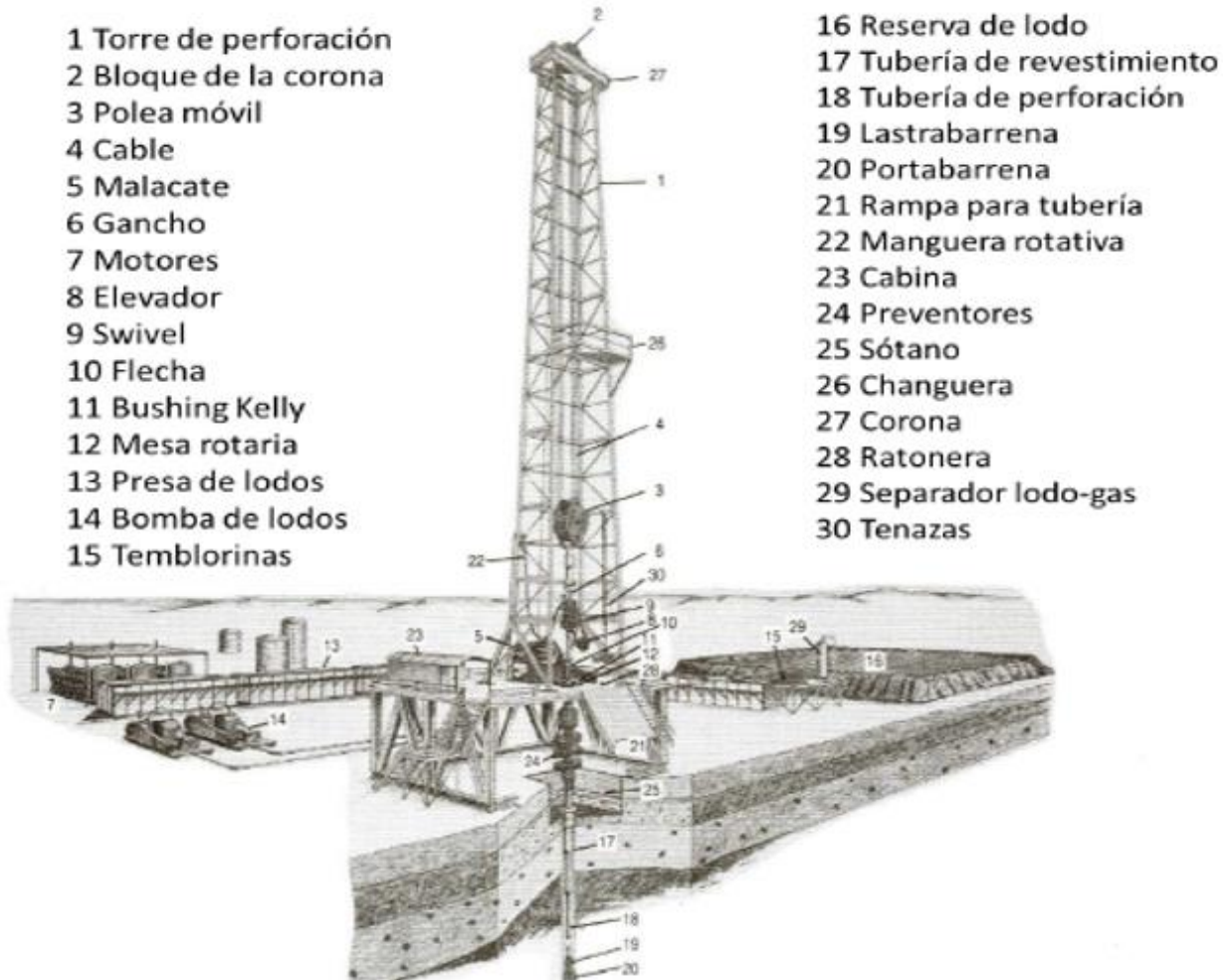
Figura 44.- Representación de un equipo de perforación completo para un pozo geotérmico (manual de perforación “GRUPO ENAL”)
