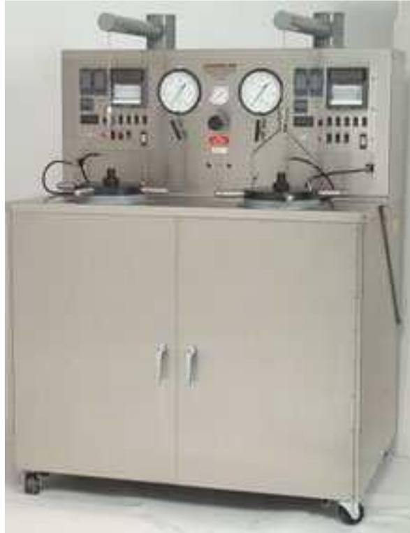
Figura 66.- Representación de un consistómetro para el tiempo de bombeabilidad en un pozo geotérmico (Revista de Energía Geotérmica de Chile)
