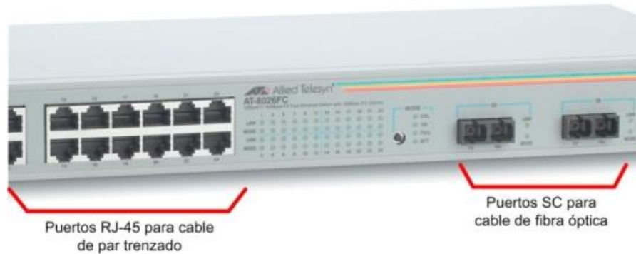
ILUSTRACIÓN 20 TIPOS DE PUERTOS DEL SWITCH
