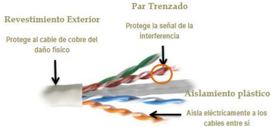
ILUSTRACIÓN 9 CABLE PAR TRENZADO SIN BLINDAJE
