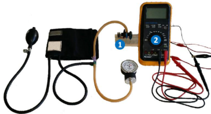
Fig. 26: Disposición de los elementos para la visualización de la presión y voltaje entregado por el sensor. 1: Elemento de sensado; 2: Multímetro digital.
