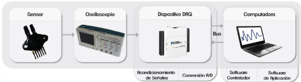
Fig. 36: Elementos del sistema de adquisición de datos.
