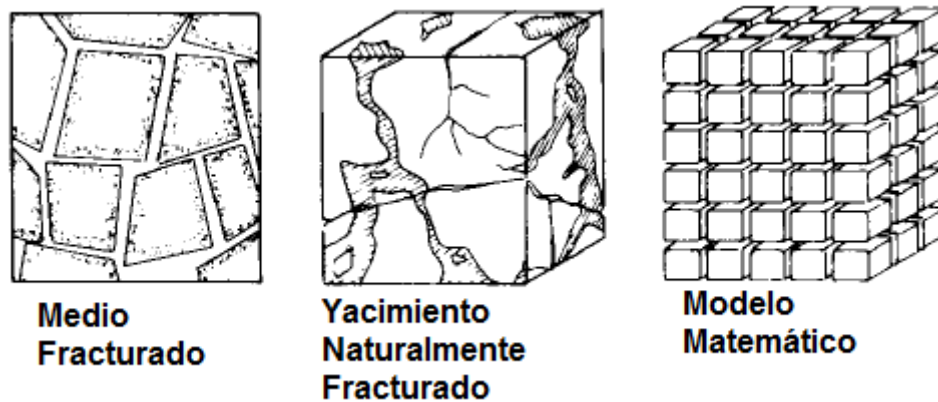
Figura 2.6. Representaciones esquemáticas de un medio fracturado (Modificado de Warren y Root, 1963).
