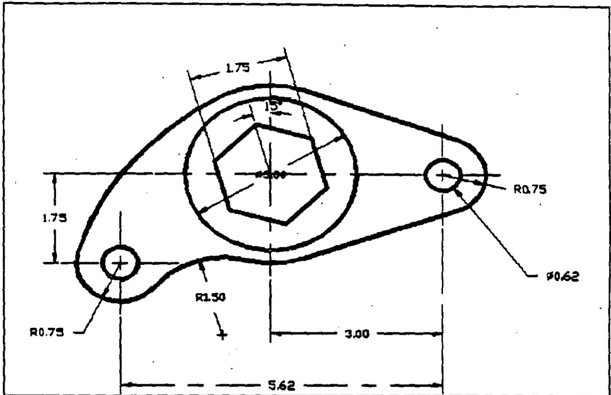
Para que un dibujo defina completamente un diseño, además de la representación gráfica de entidades y anotaciones, es necesario acompañarlo de acotaciones (dimensiones), tolerancias e información clave suficiente para su manufactura o construcción.
