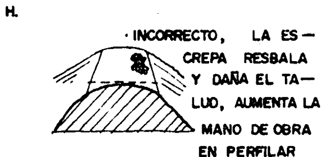
FORMACION DE TERRAPLENES
