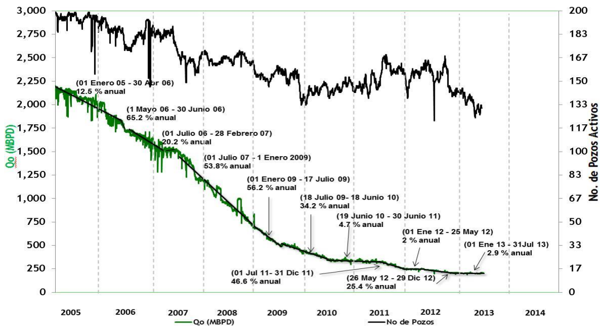
Figura 4.4 – Comportamiento de producción, declinación y pozos inyectoros de 2005 a 2013 del campo Akal (24).
