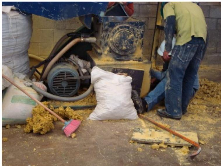
Fig. 57 Falta de limpieza en maquinaria
