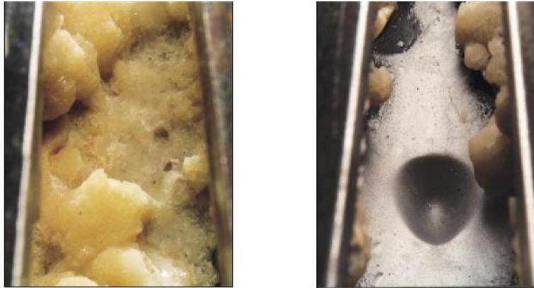
Figura 2.11 Eliminación de incrustaciones de carbonato de calcio con chorros de agua y con agua abrasivo (con arena abrasiva) <sup>9</sup>
