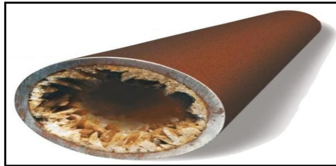
Figura 2.10 Presencia de incrustaciones en una tubería. Ejemplo: En un pozo del campo Millar en el Mar del Norte, los ingenieros se sorprendieron al ver descender la producción de 30.000 Bls/D[4770 m<sup>3</sup>/d] a cero en el lapso de 24 horas.<sup>9</sup>
