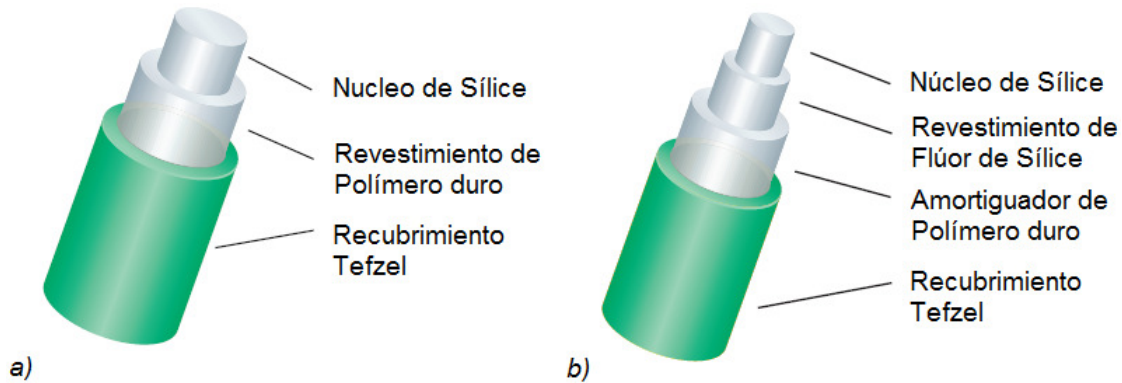
Figura 2.21. Estructura de las fibras a) FT-400-URT y b) FG-200-LCR [22]
