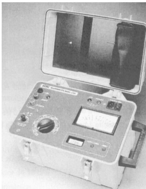
Fig. 41. Megger de aislamiento 5000V, AEMC.<sup>35</sup>
