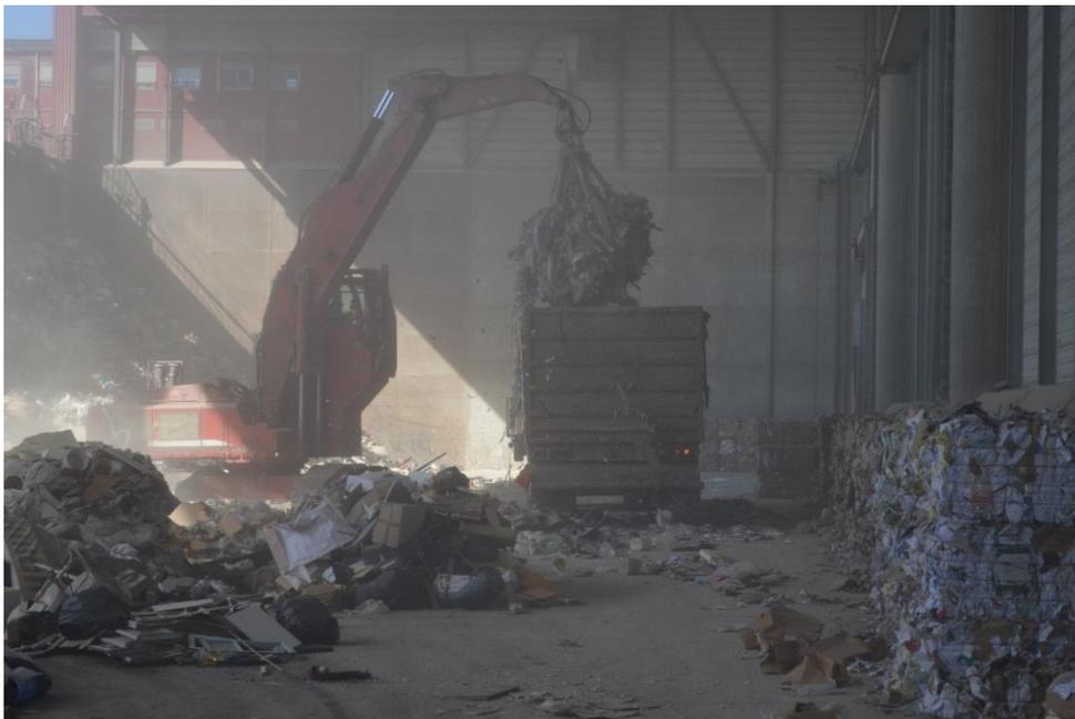
**Figura 41. Carga en camiones pequeños para llevar los residuos a las celdas.**
