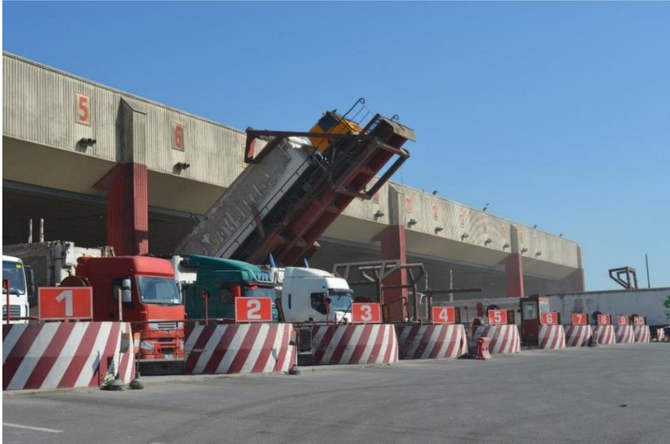
**Figura 40. Descarga de camión hacia el patio de maniobra.**
