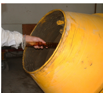
Figura 2.6 Incorporación de aditivo Pozzolite 322 N
