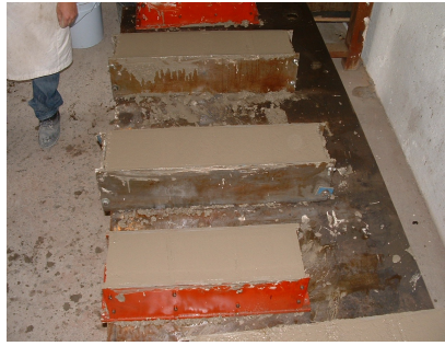
Figura 2.9 Moldeado y vibrado de especímenes
