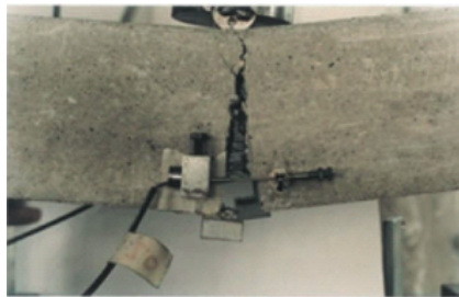
Figura 1.4 Instrumentación de ensayo de flexión en tres puntos (EN 14651)
