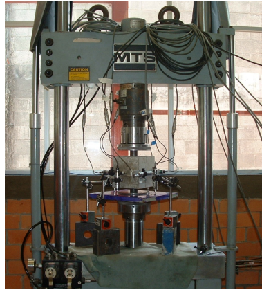
Figura 3.2 Equipo MTS y montaje de ensayo MDPT
