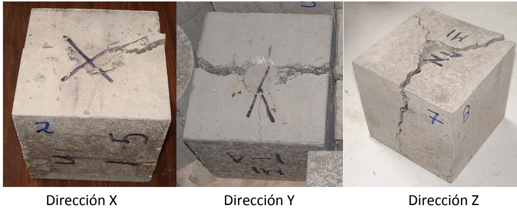
Figura 3.3 Modo de falla ensayo MDPT
