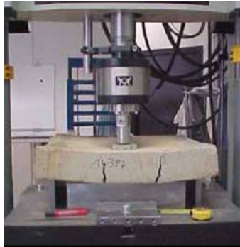
Figura 1.6 Configuración del panel cuadrado (EFNARC, 1996)
