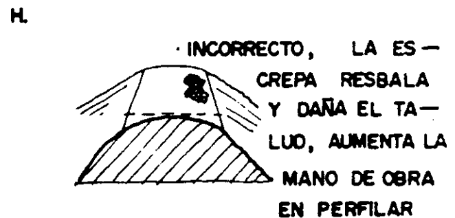
FORMACION DE TERRAPLENES
