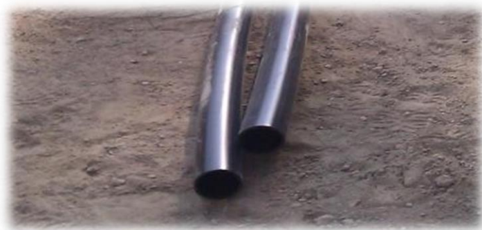
Figura 27. Poliducto de PAD.
