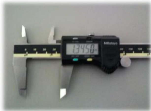
Figura 78. Regla digital milimétrica empleada para medir la saliente del pistón (deformaciones); en algunos casos y para mayo precision se usa una base magnetica como apoyo.
