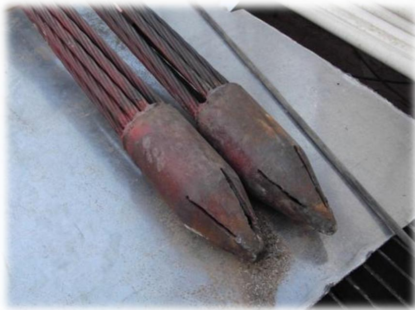
Figura 49. Colocación de punta cónica metálica hecha en obra o punta de cónica comprada.
