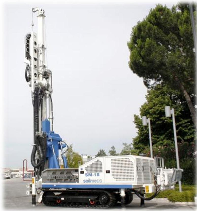
Figura 53. Perforadora SOILMEC SM-18.
