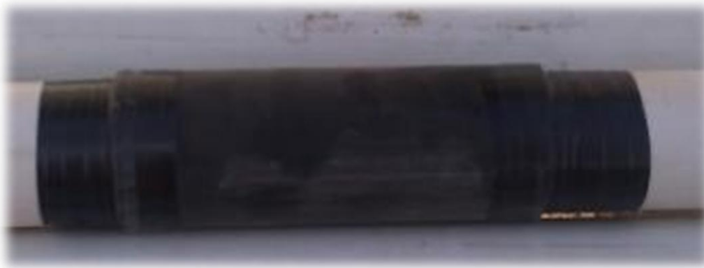
Figura 32. Tubo de PVC con manguito y cinta de aislar.
