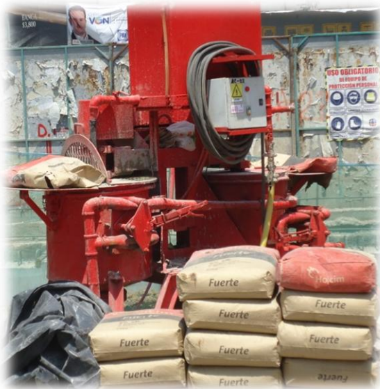
Figuras 61. Central de inyección PH 2x5 con agitador y mezclador AC-2
