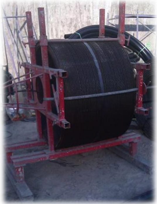
Figura 35. Contenedor de bobina para corte de cable torón de 15 mm con cortadora para metales.
