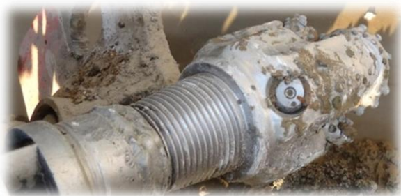
Figura 52. Broca tricónica 5 7/8" instalada en barra de perforación.
