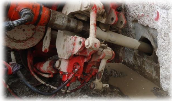
Figura 56. Perforación rotatoria con broca cola de pescado
