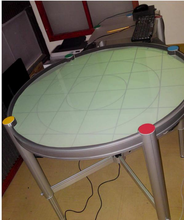
Figura 3.15. Proyección de plantilla para la calibración de la cámara
