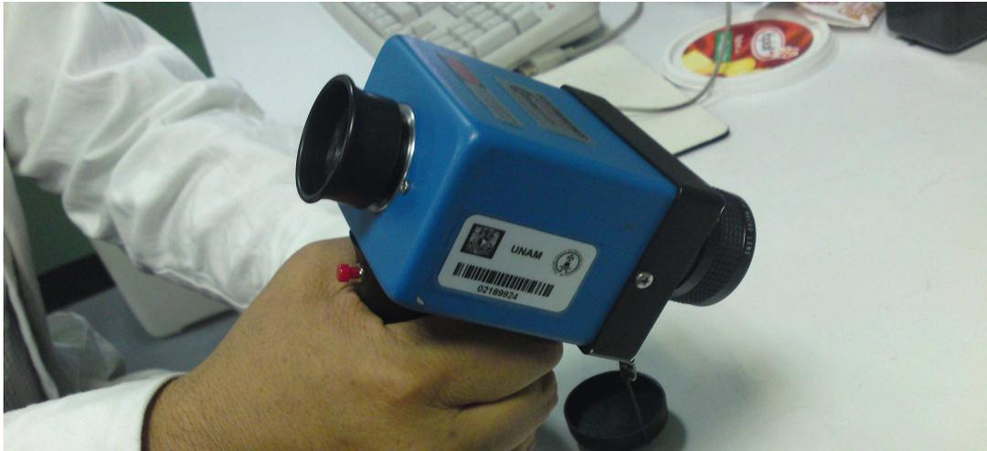
Figura 3.13. Visor de radiación infrarroja.
