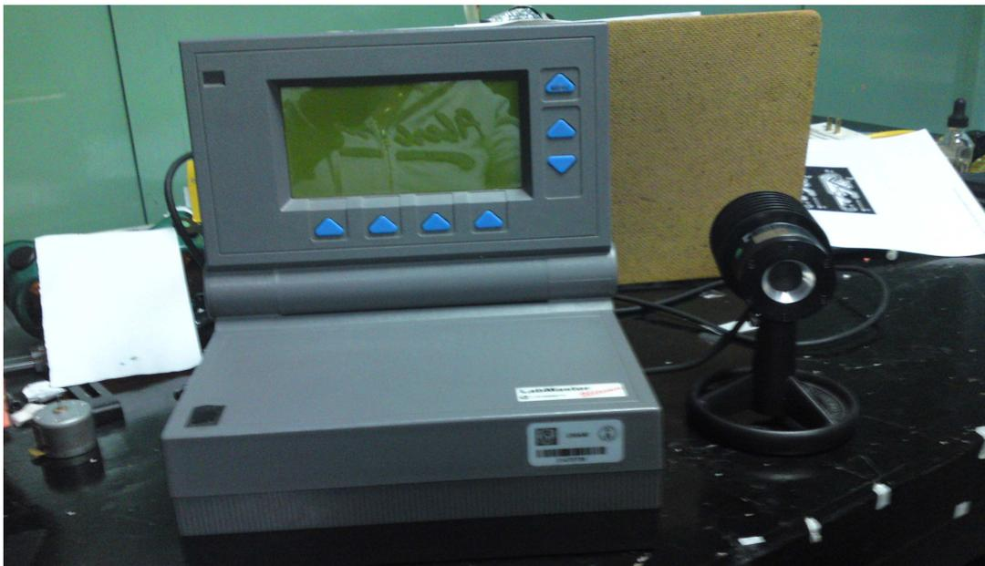
Figura 3.14. Fotómetro Ultima LabMaster empleado.
