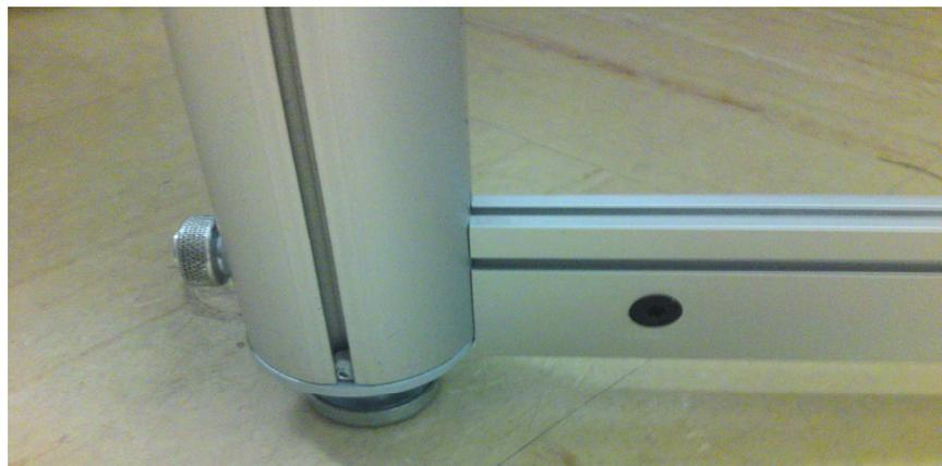
Figura 3.1. Unión entre perfil horizontal y perfil redondo.
