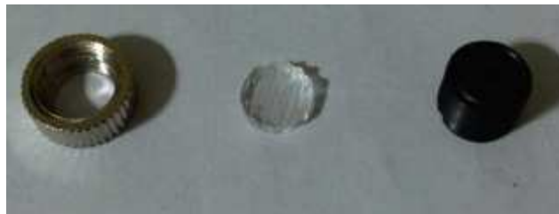
Figura 2.14. Anillo de montaje, lente generadora de línea y lente colimadora.
