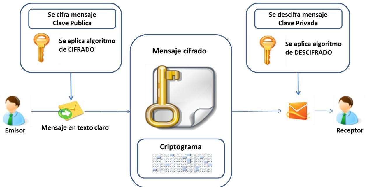
Fig. 3.4 Esquema de cifrado de un mensaje
