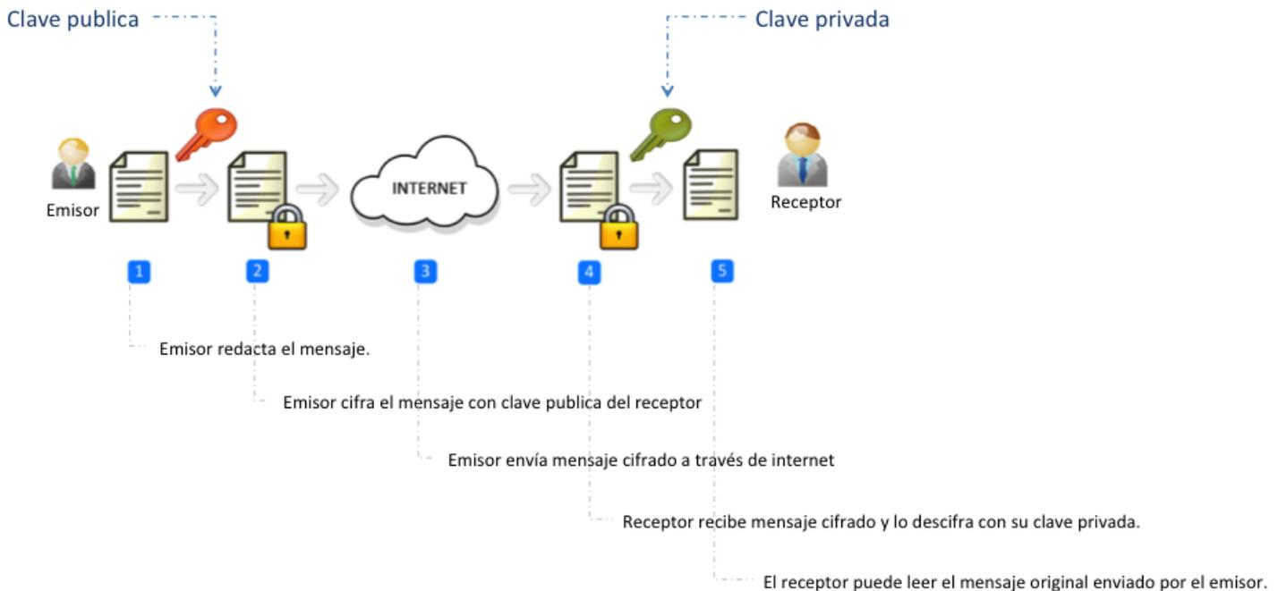
Fig. 3.8 Esquema de cifrado asimétrico
