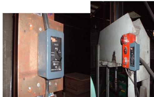
Figura 2.16 Caja de fusibles en mal estado utilizada como arrancador de cizalla
