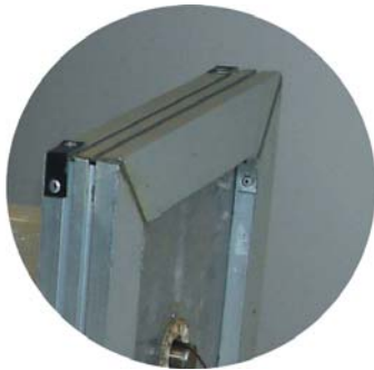
Foto 1. Perfil y placa remachados.
