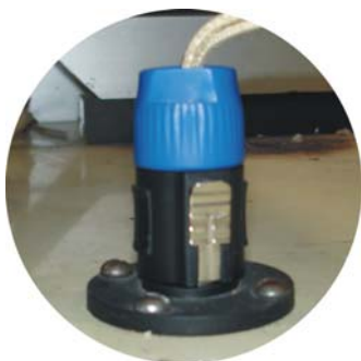
Foto 6. Conectores neutrick de la resistencia calefactora.
