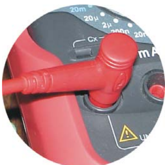
Foto 8. Conectores banana del amperímetro.
