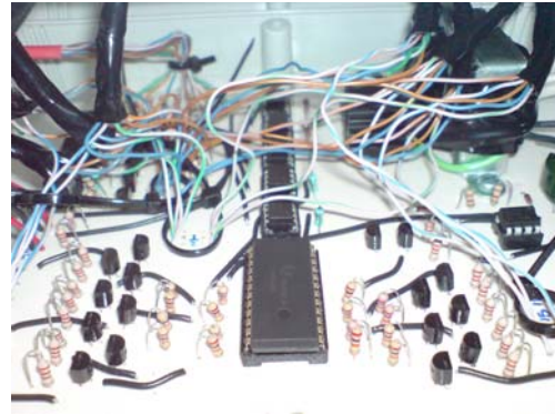
Ilustración 79 Gabinete circuito selección de lámpara y su interior
