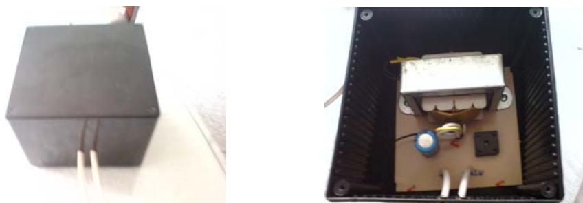
Ilustración 76 Fuente de Alimentación para Iluminación
