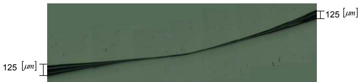
Figura 9 Fotografía de fibra óptica monomodo adelgazada en la estación acopladora del laboratorio.
