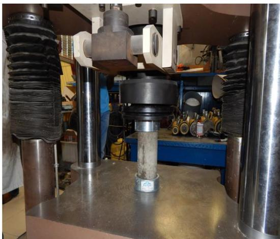
**FIGURA 5.4** Ensaye de cilindro a compresión.
