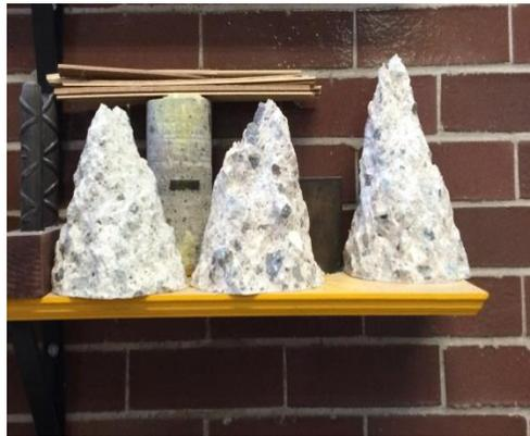
**FIGURA 5.9** Tipos de falla y apariencia de concreto en diferentes cilindros ensayados.
