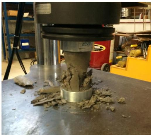
**FIGURA 5.7** Punto de ruptura del cilindro.
