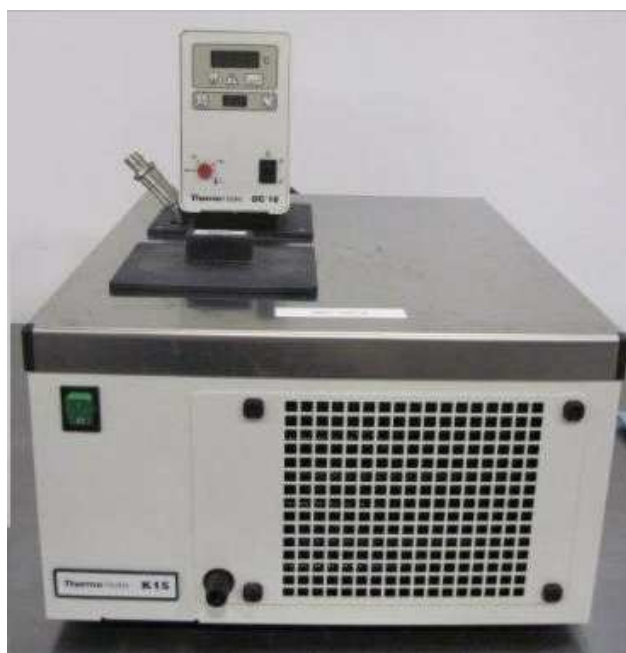
Figura 3.5: Sistema de baño térmico-Thermo Haake K15
