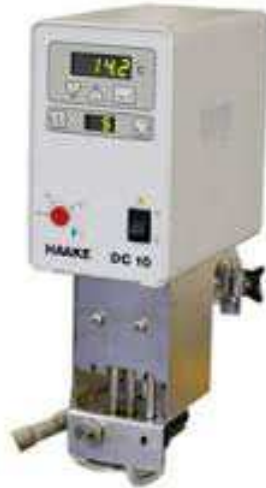
Figura 3.6: Sistema de recirculación-Circulator DC10
