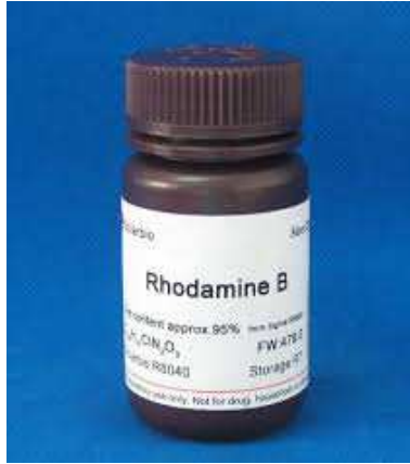
Figura 3.11: Colorante usado como indicador de temperatura-Rodamina B.
