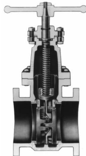
Ilustración 3. Válvula de compuerta. FUENTE: CONAGUA, 2007d.
