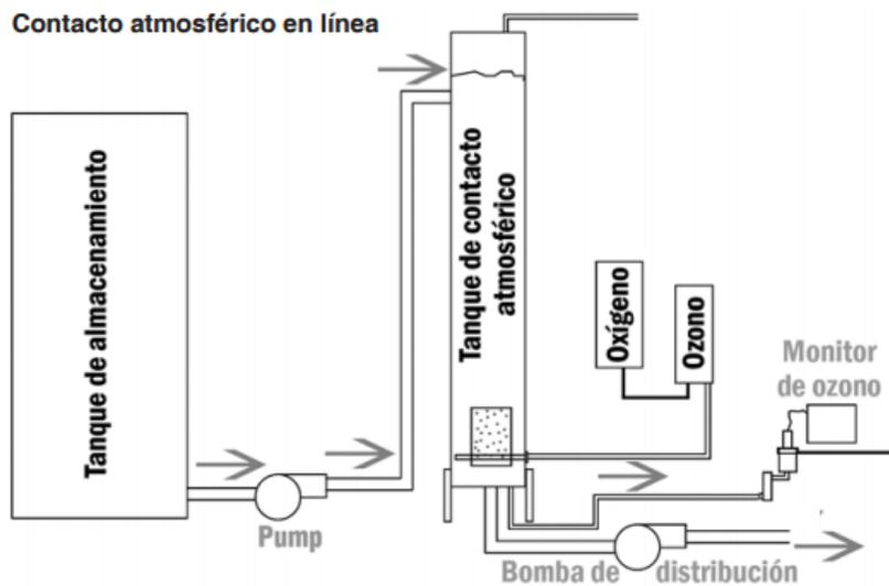
Figura 11. Contacto atmosférico en línea. FUENTE: SWANCARRA, 2008.
