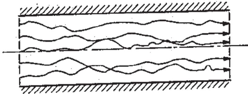
Figura 7. Esquema del flujo turbulento. FUENTE: SOTELO, 1997.
