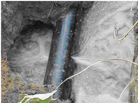
Ilustración 7. Fuga en tubería. FUENTE: Alliance for Water Efficiency, 2010. Recuperada de:
