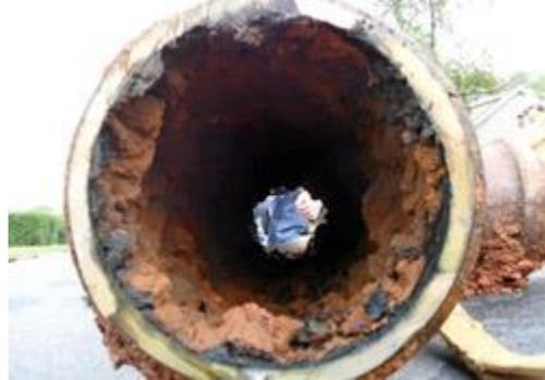
Ilustración 6. Corrosión. FUENTE: EPA, 2014.
