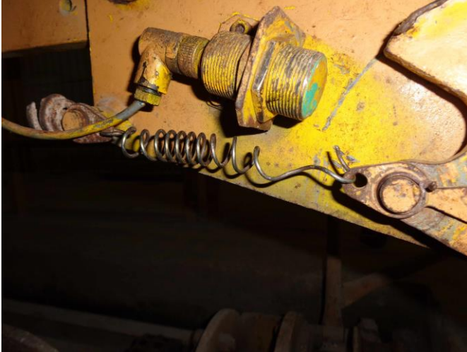
Figura 9. Sensor con resorte vencido.
