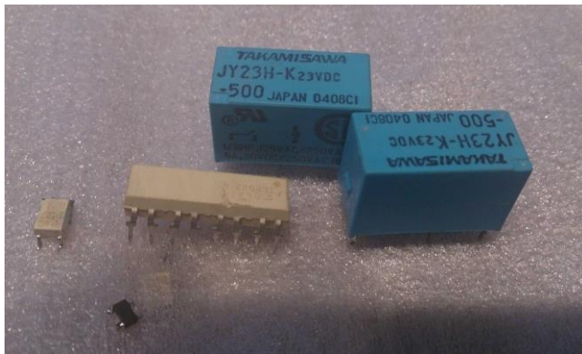
Figura 23. Algunas de los componentes electrónicos y electromecánicos dañados.
