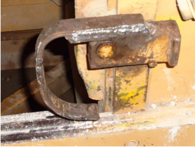
Figura 11. Sensor de fin de carrera reconstruido.
