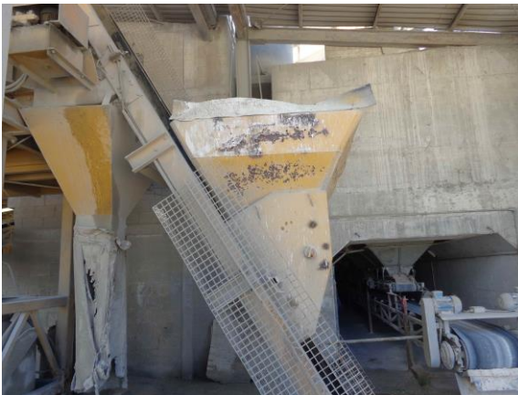
Figura 18. Tolvas dosificadoras a la derecha, “skip” al centro.
