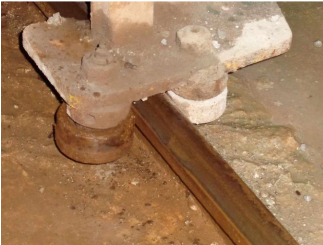
Figura 10. Rodamientos guía oxidados y pegados.
