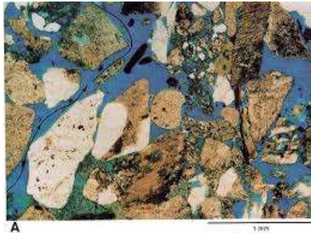
Figura 2.8 Se observa un ejemplo de la permeabilidad de la roca, las flechas en el lado izquierdo indican el flujo que puede tener un fluido a través de los poros
